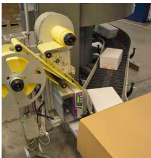
Etikettapplikatorn får all nödvändig produktionsdata från affärssystemet M3 via CodeIT Enterprise. Här märks distributionsförpackningar till populära norska pastan Soppa.
